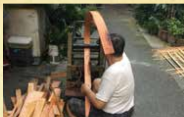
絞圓機：將浸過水之竹片彎曲，再塑形成圓。
