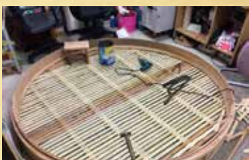
6 使用竹片，一片片如插榫似的接合在圓形蒸籠框上，做6呎蒸籠底部。
