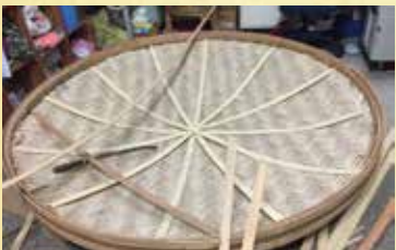
10 與蒸籠框接合成蒸籠蓋。
