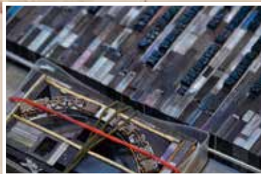
字距及行距由尺寸大小各異的「鉛角」層層堆砌而定，這不僅仰賴排版師傅對尺寸的熟悉度，更需具備完整的空間與美感概念。
