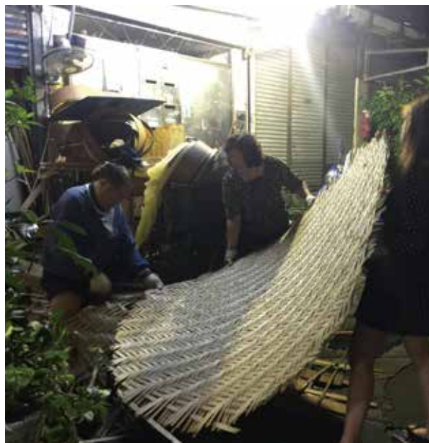
6 呎大蒸籠製作頗為耗費體力，需 3～4 人合力手編蒸籠底面。
